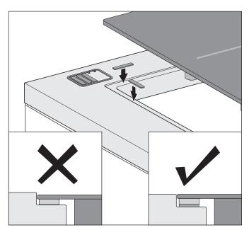
Prüfen Sie die korrekte Höhe des eingelegten Kochfelds. Wenn erforderlich, platzieren Sie passende Höhenausgleichsplatten unter dem Dichtungsband.
