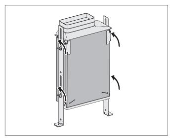
Die Höhe des Umluftfilters muss so eingestellt werden, dass ein vollständiges Aufklappen zur Entnahme der Filterpatrone jederzeit gewährleistet ist.
