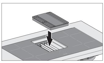
Setzen Sie das Einströmgitter auf den Abscheideeinsatz.
