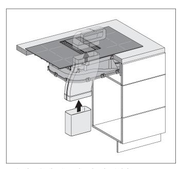
🖙 Stecken Sie den Bogenkanal in den Rohrbogen.
