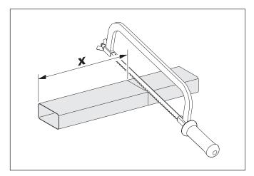
Schneiden Sie passende Flachkanalstücke. Anzahl und Länge müssen zur Einbauvariante passen.
