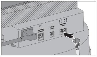
Stecken Sie den Anschlussstecker vom Umluftfilter permalyt in den Steuerungskasten am Lüftergehäuse.
