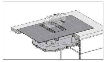
Stecken Sie den Rohrbogen in den Anschluss am Lüftergehäuse.
