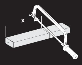
Schneiden Sie passende Flachkanalstücke. Anzahl und Länge müssen zur Einbauvariante passen.
