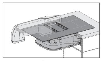
Stecken Sie den Umluftbogen in den Anschluss am Lüftergehäuse.
