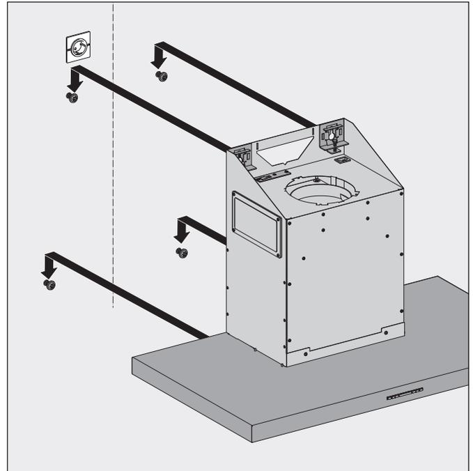
☞ Hängen Sie das Gerät an den Befestigungspunkten auf.
