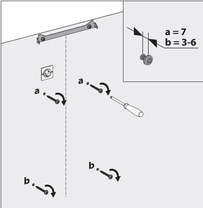
Die oberen Befestigungsschrauben werden erst nach Ausrichtung des Geräts festgezogen.
